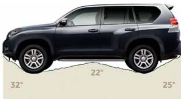
Rampvinkel mellan hjulparen 22° Frigångsvinkel fram 32° Frigångsvinkel bak 25°
